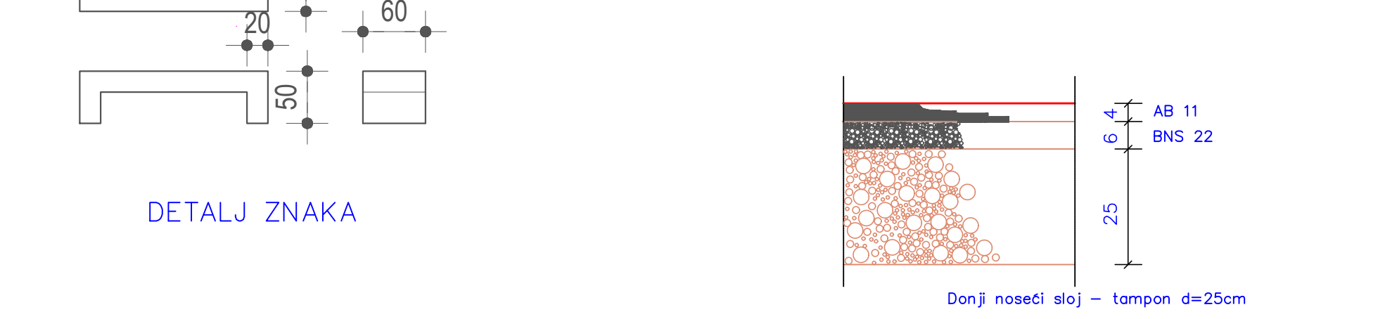
DETALJ KOLOVOZNE KONSTRUKCIJE PRILAZ GARAZI
