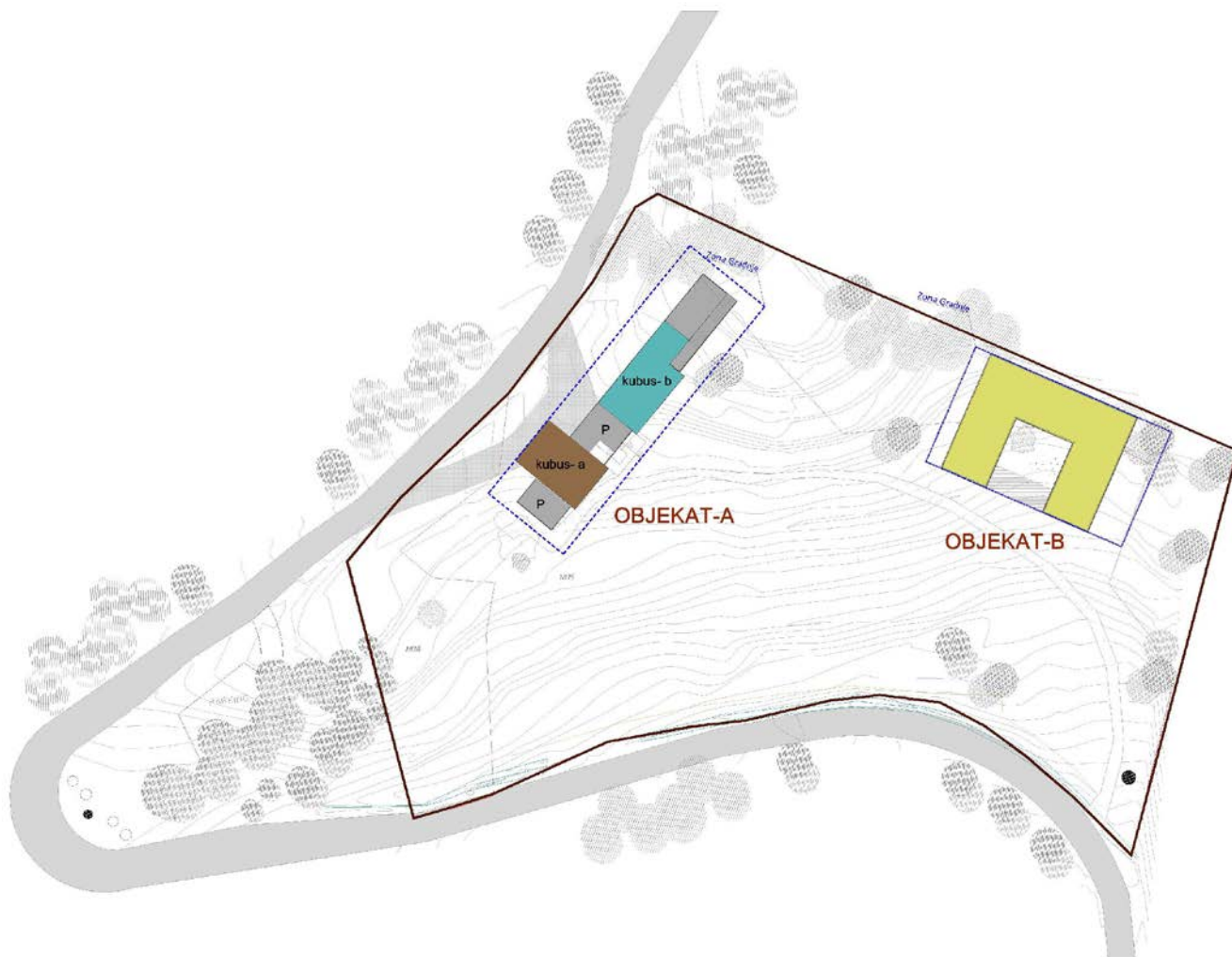
Slika 1. Situacioni plan vinarije i pomocnog objekta (objekat A, objekat B, kubus a, kubus b, poluukopano prizemlje P)
